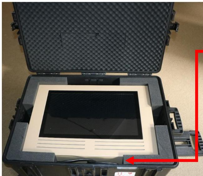
Dann Medientisch in den Koffer einbringen. Dabei das **Stromkabel nach oben führen** und **in der Aussparung platzieren**.
