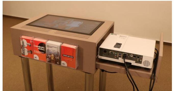
Das Bild des Displays wird bei Anschluss des Projektors gespiegelt auf dem Projektor ausgegeben. Beim Anschluss kann es zu einem kurzen Schwarzbild des Displays kommen. Bitte achten Sie darauf, dass der angeschlossene Projektor das Bild in Full-HD (1920 x 1080p) ausgibt. Diese Auflösung ist ggf. in den Projektoreinstellungen einzutragen.
